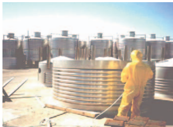
Pulizia di serbatoi enologici di stoccaggio (Rioja - Spagna).
