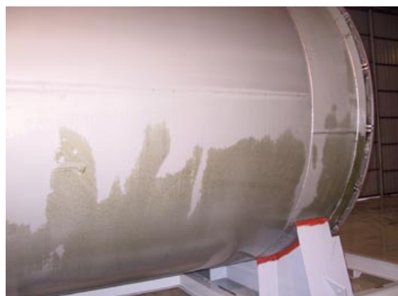
Avesta FinishOne™ – rinçage pour enlever la contamination ferreuse (les taches brunes vues sur la photo).
