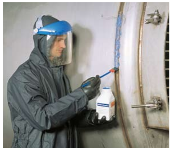
Avesta BlueOne™ Pickling Paste 130 – wytrawianie spoin przy użyciu pędzla kwasoodpornego
