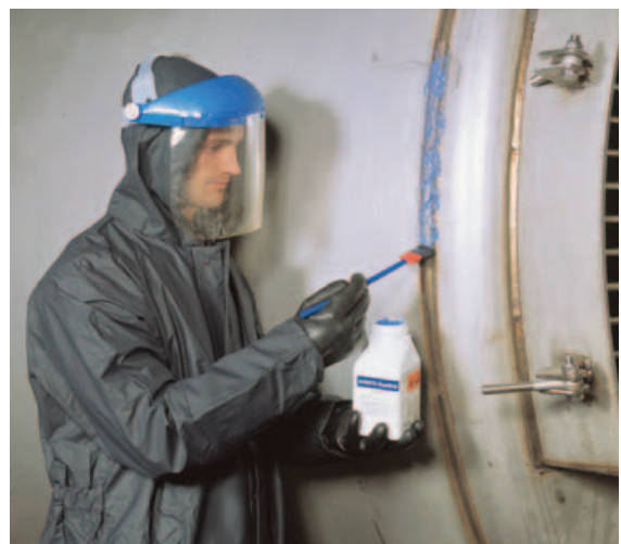
Avesta BlueOne™ Pickling Paste 130 – decapaggio a pennello nel rispetto della Direttiva BAT (Best Available Technique).
